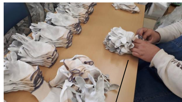
【軍手の検品】①サイズごとに違う色別に分ける ②左右をセット ③不良品を除く ④10双で紐止め×10セットにする ⑤出荷
